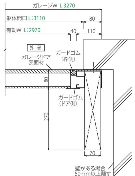
注意: 接地面からサイドフレームを10mm持ち上げた状態で固定してください。10mmくらい浮かすと接地面にゴムが擦りません。
